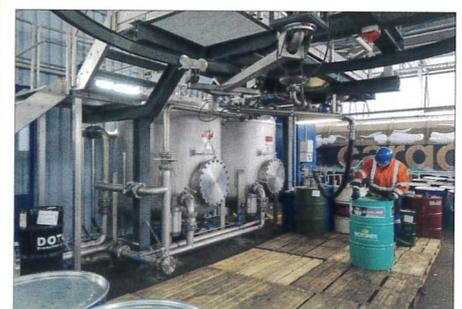
Dank einem Schwenkarm, der einer kreisförmigen Schiene folgt, kann der Mitarbeiter ohne besonderen Kraftaufwand Fass für Fass das Öl sammeln.
